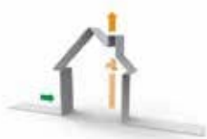
Systeem C natuurlijke toevoer, mechanische afvoer
