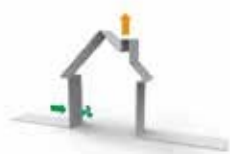
Systeem B mechanische toevoer, natuurlijke afvoer
