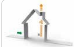
Systeem C+ ® EVO II natuurlijke toevoer, vraaggestuurde mechanische afvoer
