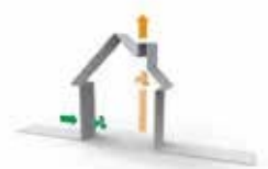
Systeem D mechanische toevoer, mechanische afvoer
